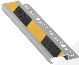
Perfil de aluminio para escalones con una superficie de pisada de 40 mm y banda antideslizante de gran dureza de 25 mm, que cumple con las normativas de seguridad standard, por lo que es un perfil de gran utilidad en zonas con mucho tránsito. El EUROPELDAÑO-299A, se coloca durante el proceso de la obra y puede ser usado indistintamente en interiores o exteriores. Disponible tapa final, referencia F-299A.
